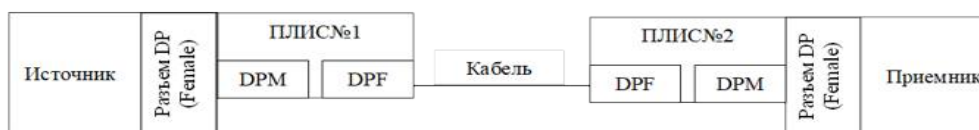
Рис. 10. Предполагаемый принцип использования ПЛИС Fig. 10. The proposed principle of using a programmable logic integrated circuit
