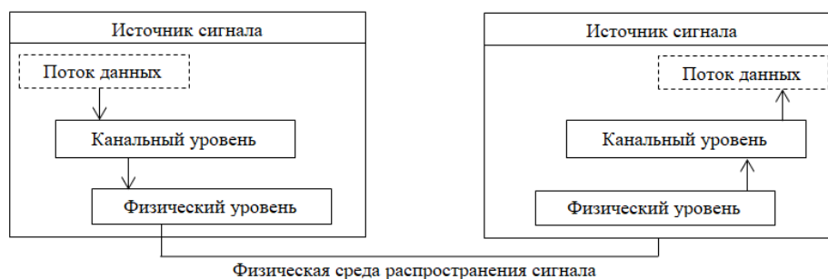
Рис. 4. Общий принцип архитектуры интерфейса DisplayPort Fig. 4. The general principle of the DisplayPort interface architecture
