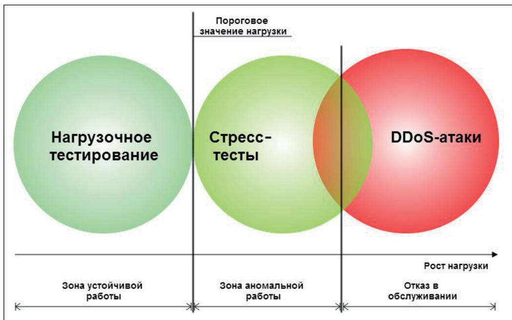
Рис. 1. Распределение множеств тестовых сценариев по мощности нагрузки на информационную систему
