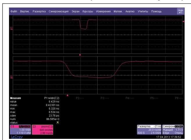
Рис. 2. Осциллограмма тактового импульса запуска лазера в режиме Range Scanning
