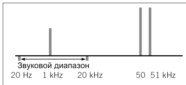
Рис. 3. Частоты накачки и разностная частота
