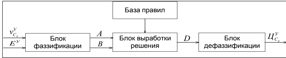
Рис. 1. Система нечеткого логического вывода параметра «Ценность информационных объектов уровня критичности Y »
