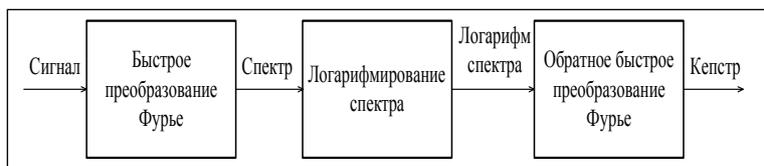
Рис. 1. Схема вычисления кепстра сигнала
