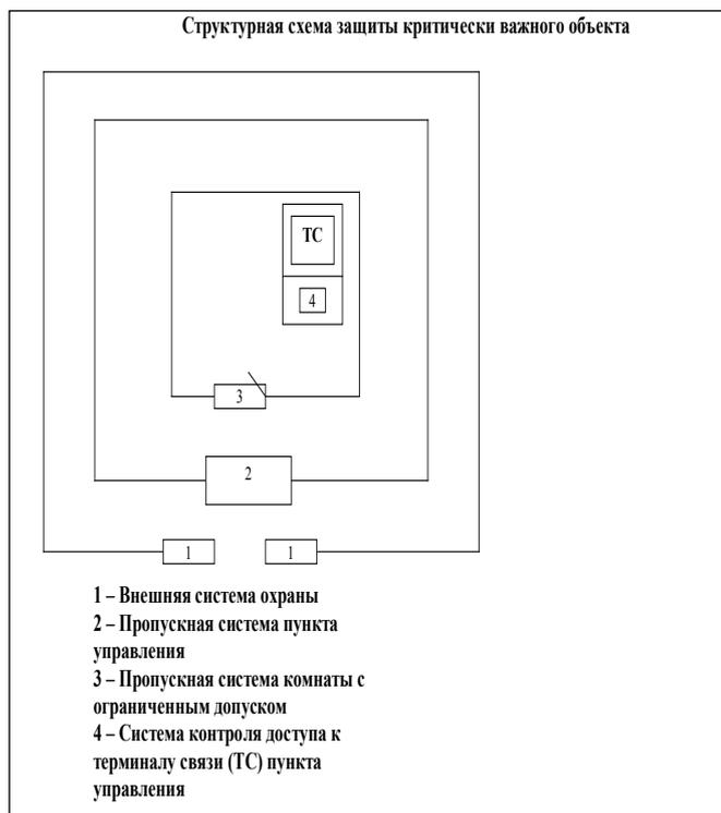
Рис. 1. Структурная схема защиты пункта управления ТКС
