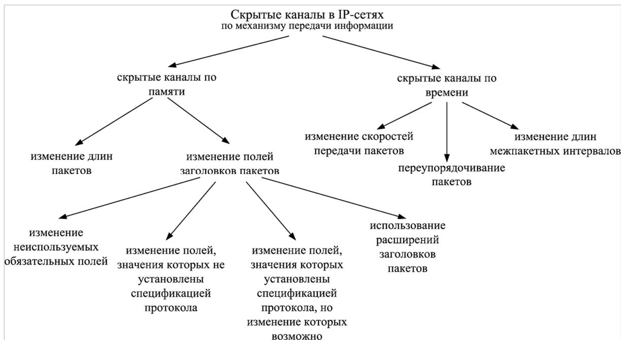
Рис. 1. Систематизация скрытых каналов в IP-сетях
