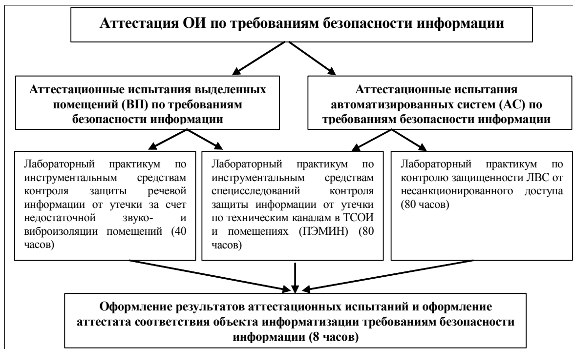
Рис. 1. Структурная схема проверки объектов информатизации в рамках аттестационных испытаний по требованиям безопасности информации.
