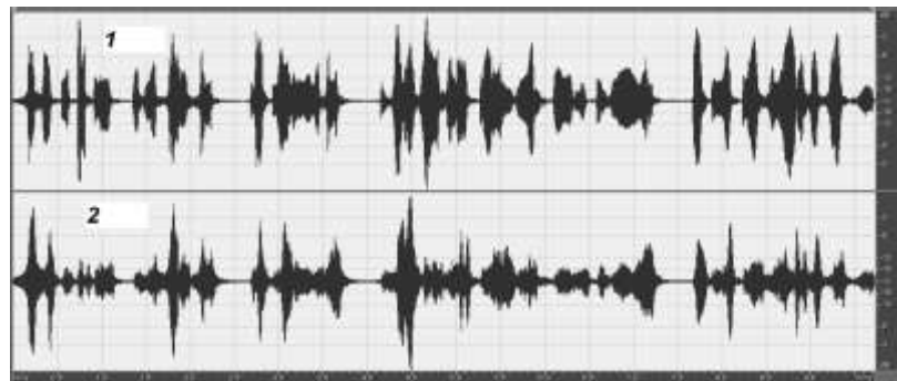
Рисунок 4 - Волновые формы речевого сигнала: 1 – исходный сигнал, отфильтрованный в полосе 100...570 Гц, 2 – отфильтрованный сигнал в полосе 100...570 Гц после применения дополнительных узкополосных фильтров
