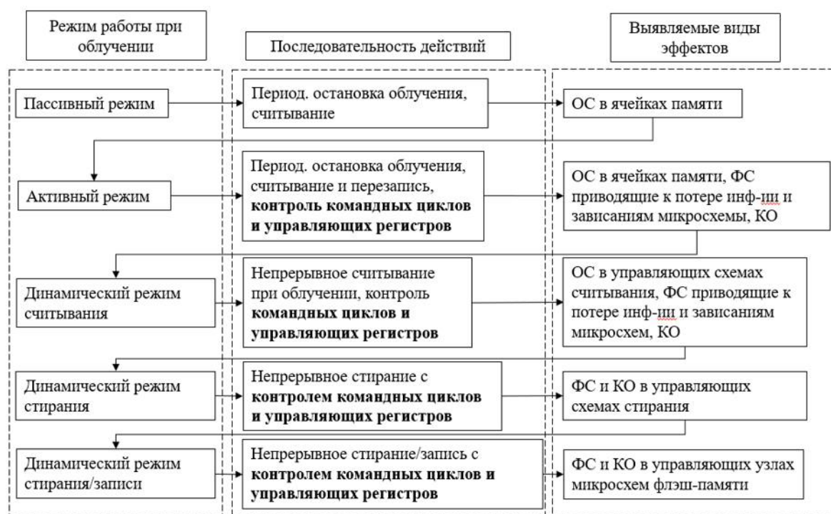
Рис. 1. Методика проведения исследований стойкости флэш-памяти к воздействию ОЯЧ по эффектам функциональных сбоев
