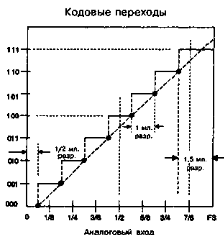
Рис. 2а. Статическая ХП АЦП (Fig. 2a. ADC static transfer function)
