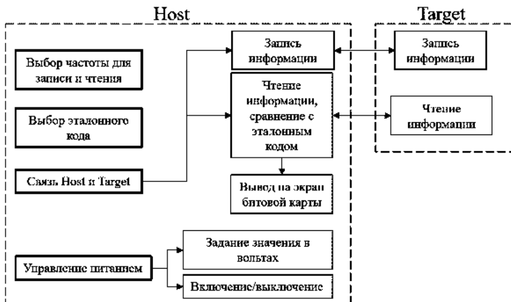
Рис. 3. Блок-схема ПО, иллюстрирующая ключевые функциональные блоки (Fig. 3. Software block diagram illustrating key functional blocks)
