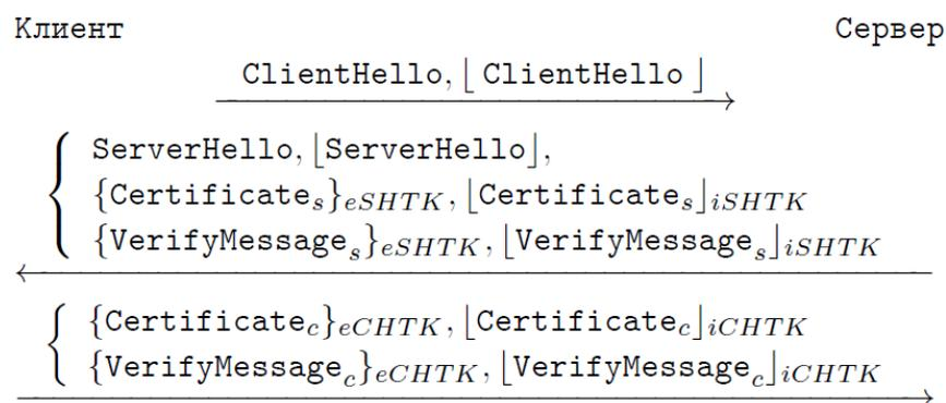
Рис. 4. Схема аутентификации на основе ключа проверки электронной подписи.
