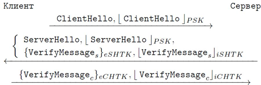
Рис. 2. Схема аутентификации на основе предварительно распределенного ключа.
