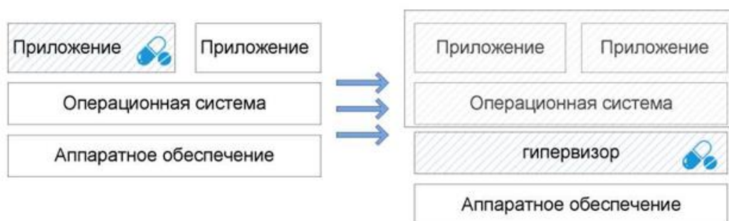
Рис. 3. Использование виртуализации в эксперименте Blue Pill Fig. 3. Using virtualization in the Blue Pill experiment
