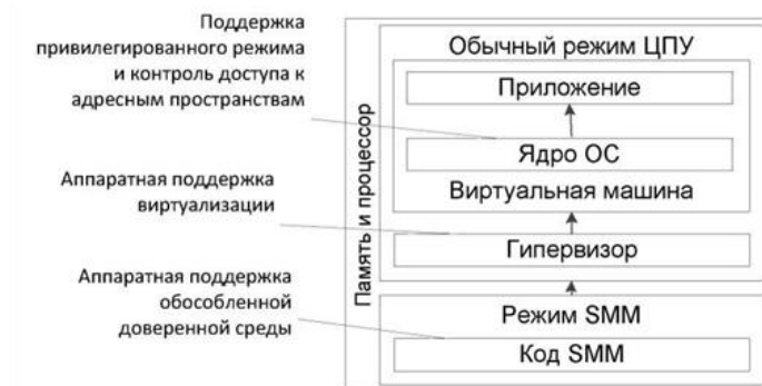
Рис. 5. Иерархия программного обеспечения в системах x86 Fig. 5. Software hierarchy in x86 systems
