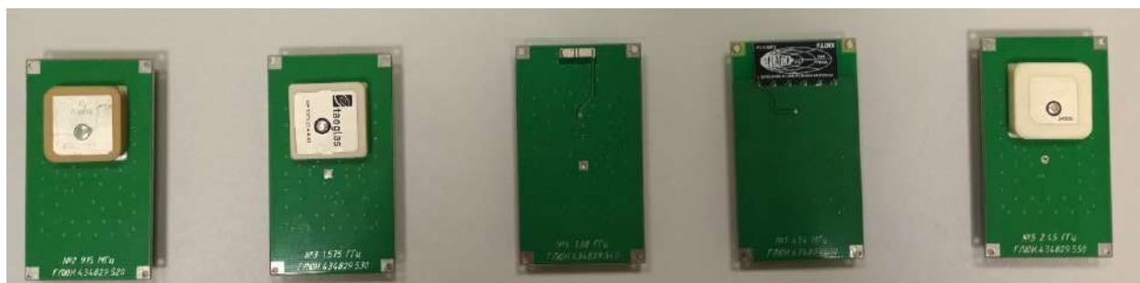
Рис. 5. Внешний вид имитаторов устройств несанкционированного съема информации
