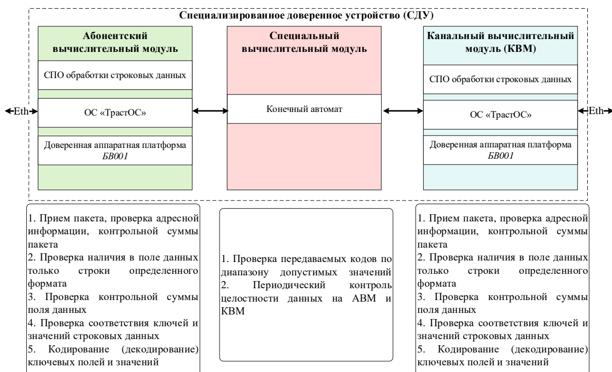
Рис. 3. Унифицированная архитектура СДУ АИ
