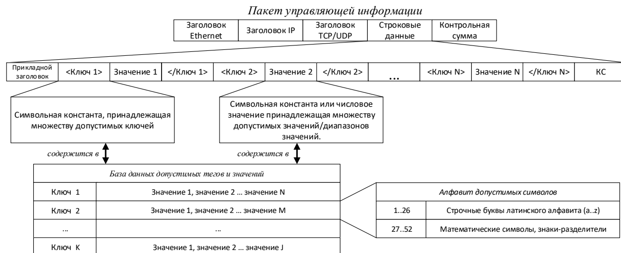
Рис. 2. Формат пакета управляющей информации Fig. 2. Controlling information packet format
