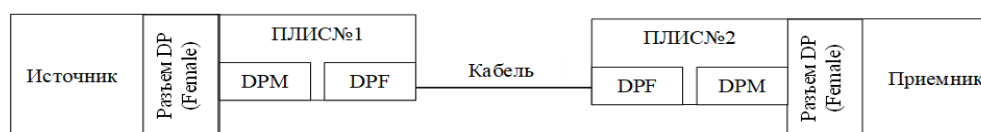
Рис. 10. Предполагаемый принцип использования ПЛИС
