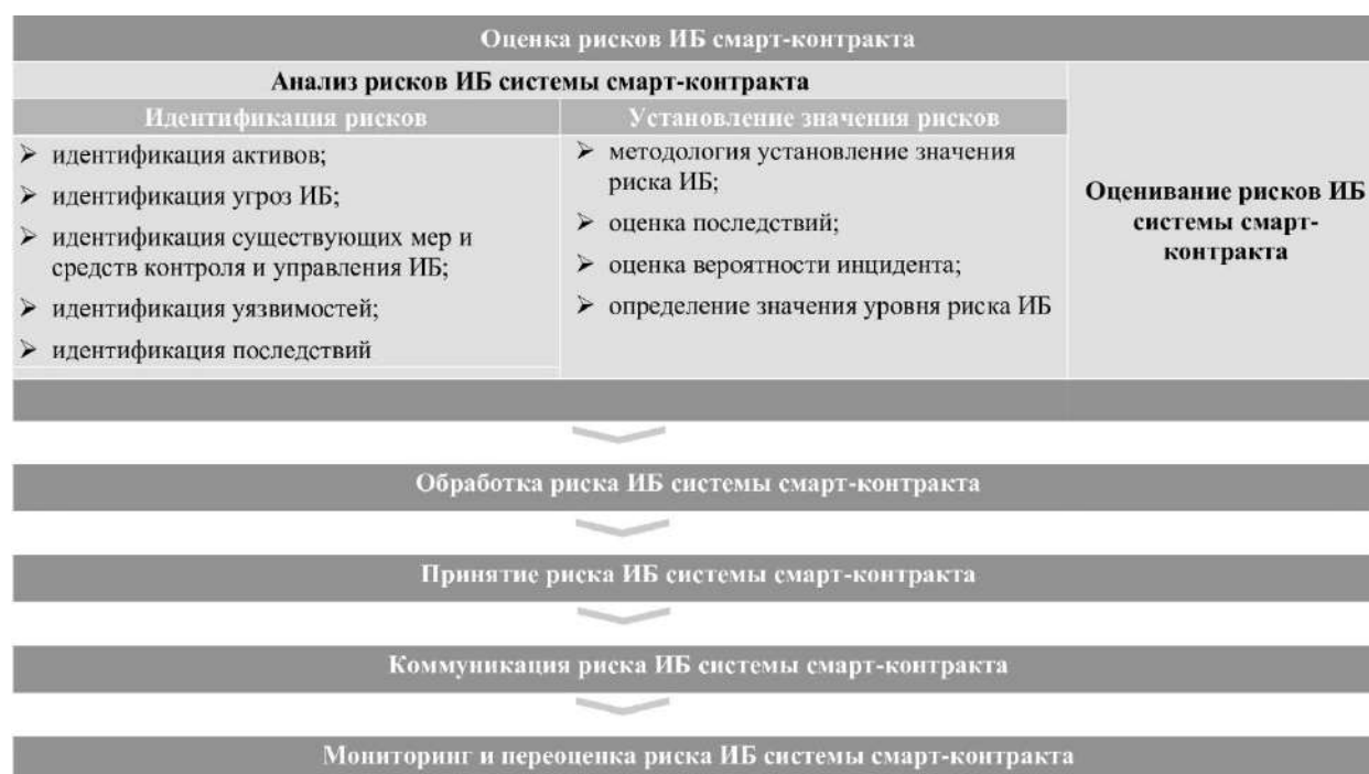
Рис. 4. Оценка рисков ИБ системы смарт-контракта Fig. 4. Risk assessment of the information security of the smart contract system
